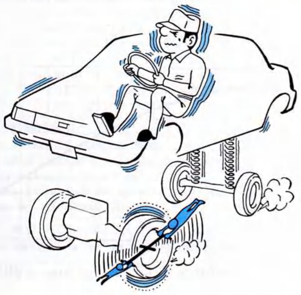
VIBRACION DEBIDO A MAL BALANCEO
